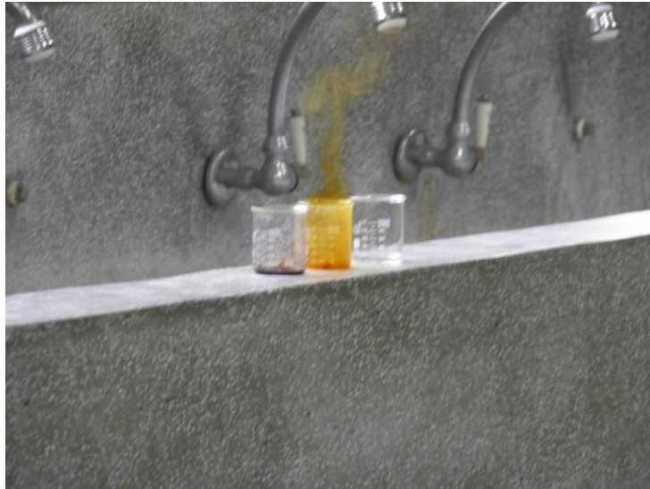
圖四、異戊二烯混入硝酸放置 10 分鐘後進入沸騰。 (燒杯由左至右分別為硫酸、硝酸與鹽酸)
