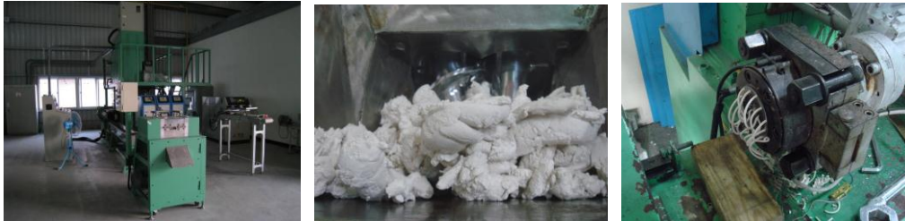
圖 2、阻燃母粒製程開發 (a)加壓式密練設備 (b)雙錐入料 (c)單螺桿擠出
