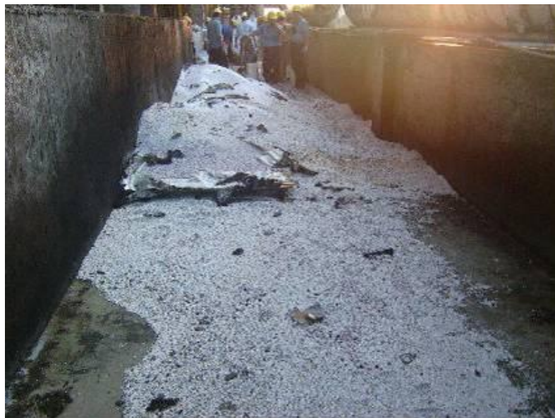
圖二、氧化鋁吸附異戊二烯於太空包封裝後燃燒分解事故現場情形
