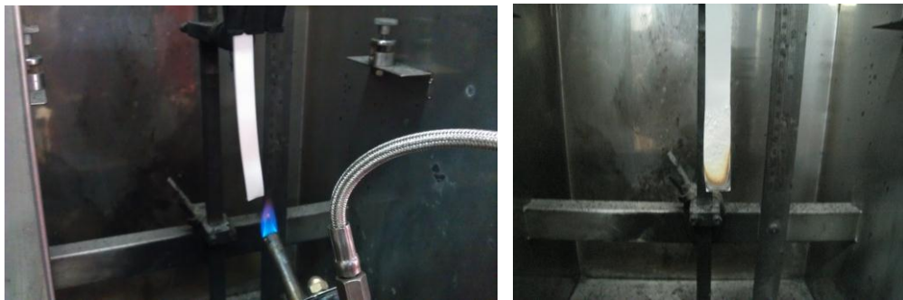
圖 6、UL-94 燃燒試驗流程 (a)測試中 (b)V0 判定
