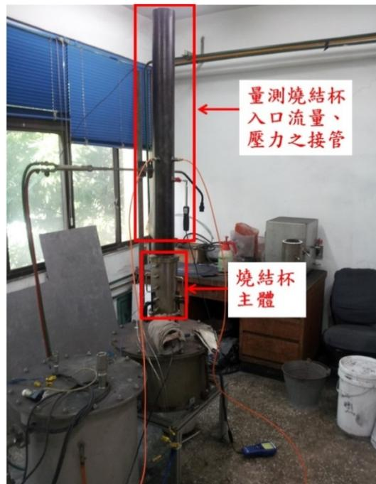
圖 5. 燒結設備加裝入口量測裝置實體示意圖
