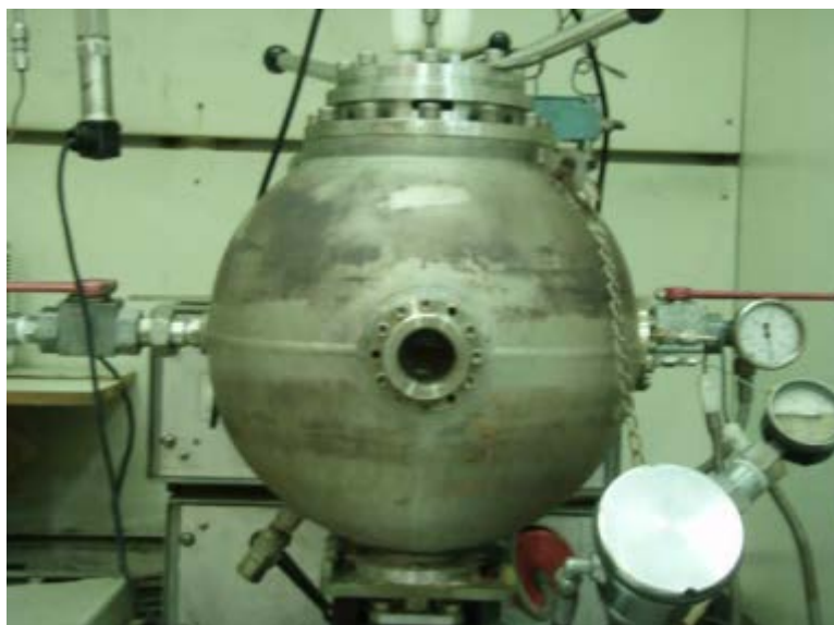
圖 1 20 升爆炸鋼球裝置圖
