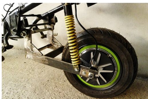
圖 2-5 支撐架與輪鼓馬達結合
