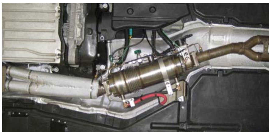
圖六 BMW X6 實際裝設熱電發電模組圖
