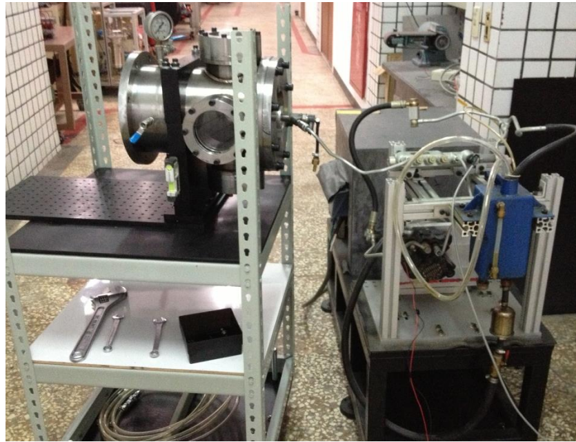
圖 1、雷射系統與高壓艙本體配置
