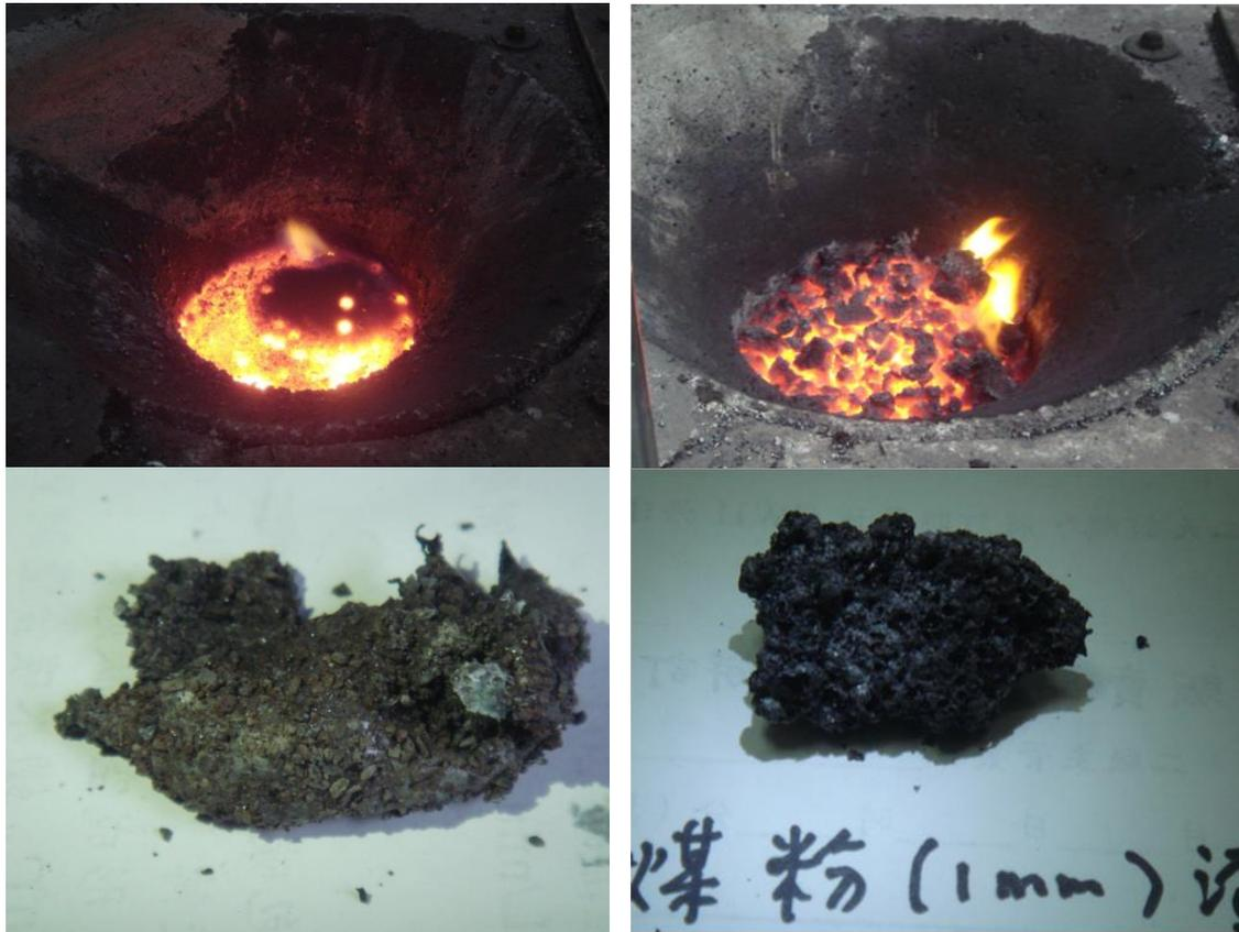
圖 22、焦炭(左圖)和煤粉(右圖)實驗後浮在鐵水的渣塊照片
