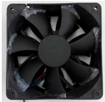
(a) 整流風罩為將另一風扇轉向並將其扇葉以熱熔膠固定
