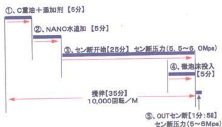
圖 4 乳化重油鍋爐專用油之製造流程
