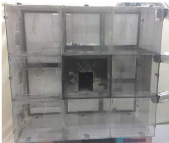
圖 2、壓克力製縮小尺度模型
