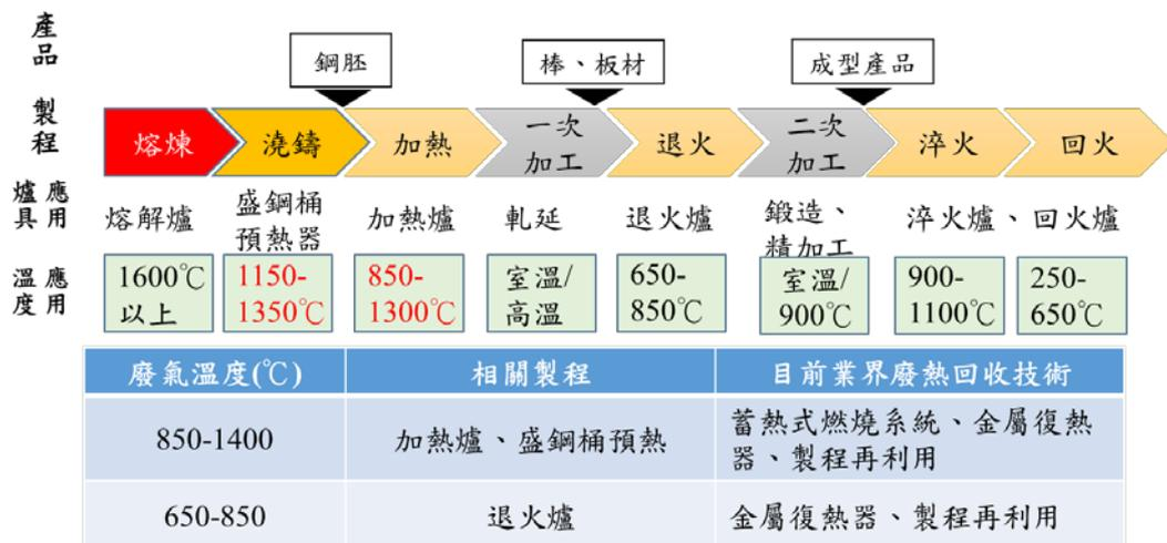
圖 1、金屬熔煉及加工製程熱能使用及廢熱回收狀況
