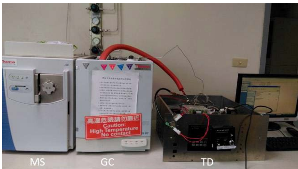
圖 5.自製線上熱脫附氣相層析質譜儀(TD-GC-MS)
