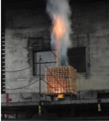
(a)單堆木框架燃燒實驗
